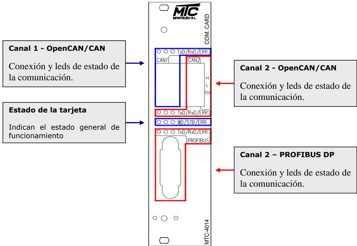
A continuación se muestra el significado de los leds:
