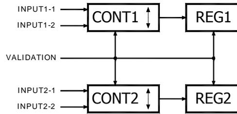
La señal de validación se puede realizar por una señal externa o mediante una comparación de uno de los contadores.
