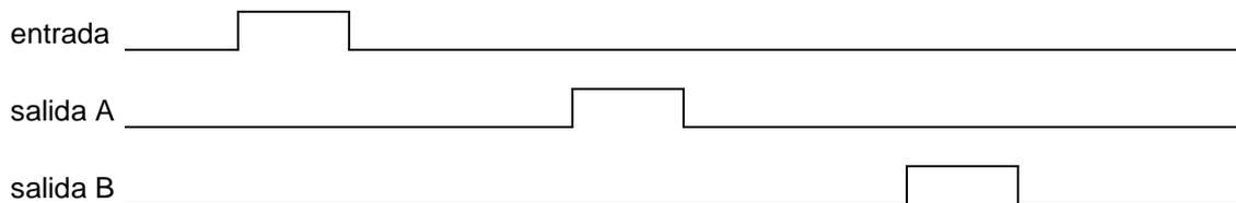
En este ejemplo, desde que se produce la entrada hasta que se genera la salida "A" han transcurrido "N" impulsos de reloj y "N+X" hasta que se genera la salida "B".
